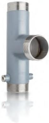
Realizado en acero AISI 304, extremidad con rosca "GAS" y orificio de G1/4" para la conexión del manómetro MC o del vacuómetro MV.
